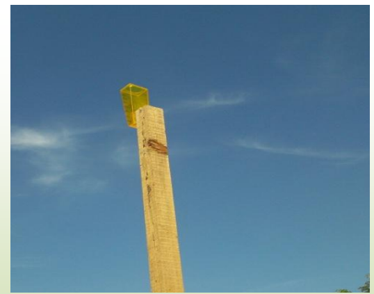
En el terreno se ha colocado un pluviómetro con el objetivo de mantener control de las lluvias que podrían afectar la obra. (Foto de FUNDE)
